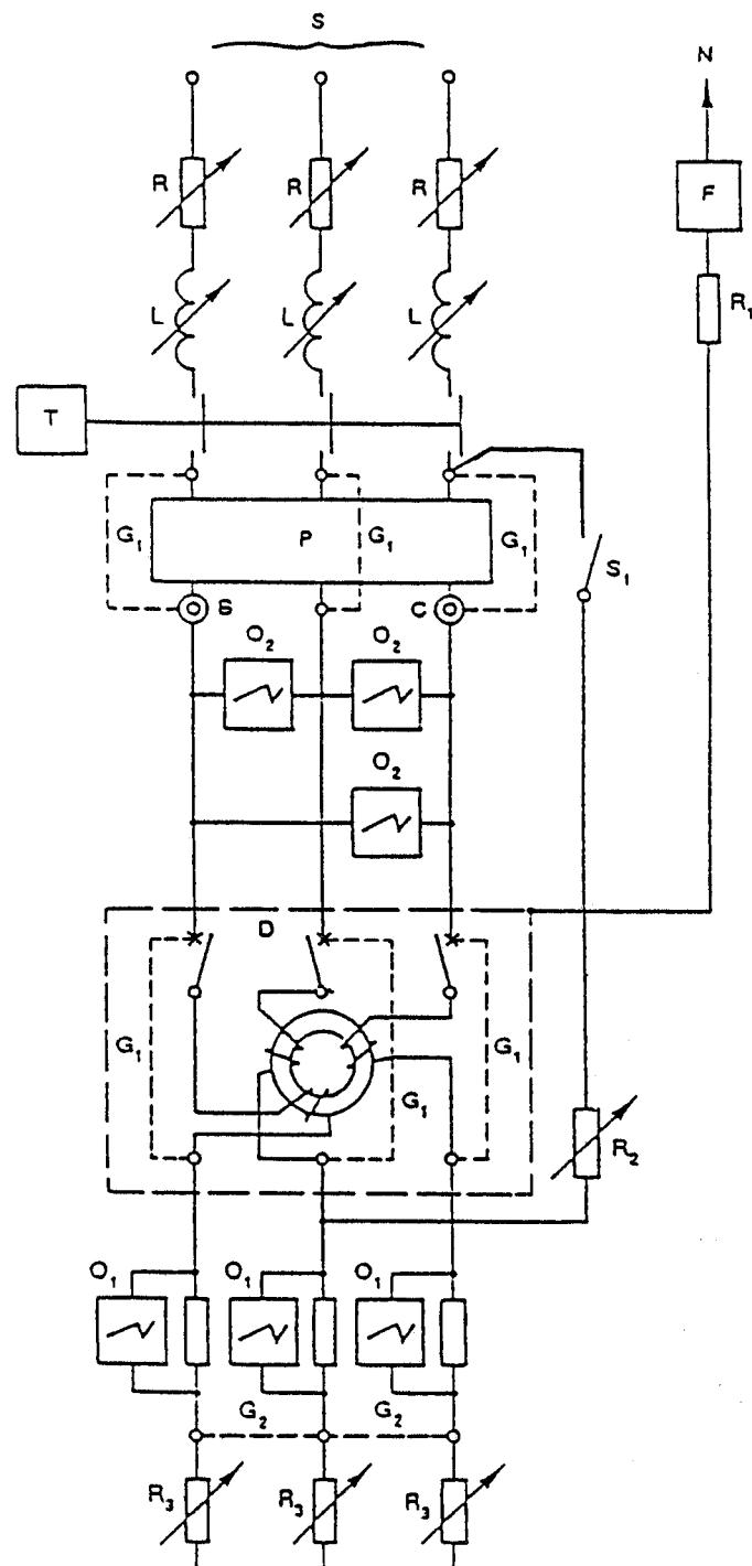
Obrázek Z1 – Zkušební obvod pro ověření jmenovité zapínací a vypínací schopnosti
